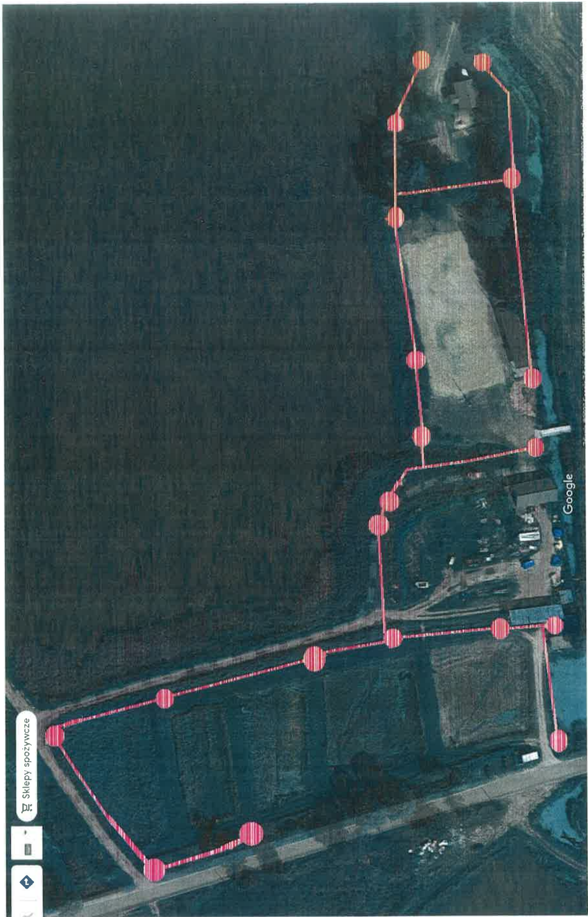
Rysunek 1 Rozkład instalacji i punkty naświetleniowe
